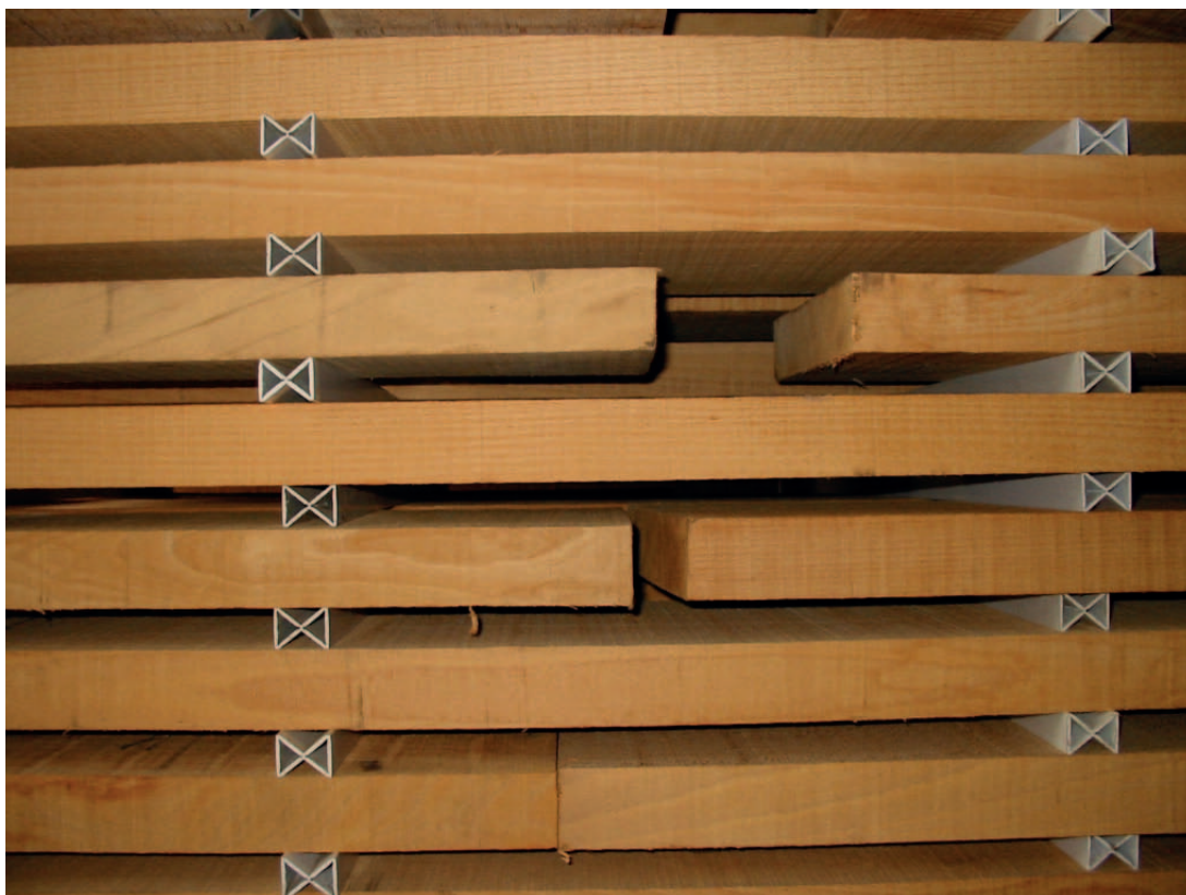
Afb. 62 Voorbeeld van een correcte opeenstapeling.
